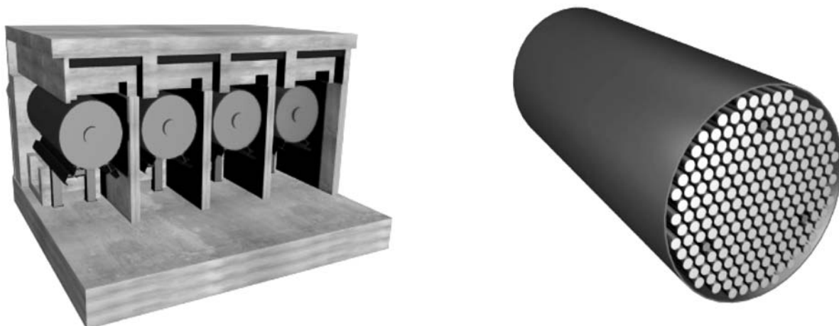
Рис. 10.2.1. Бетонный модуль хранения и сухой экранированный пенал с патронами с отработанным ядерным топливом
