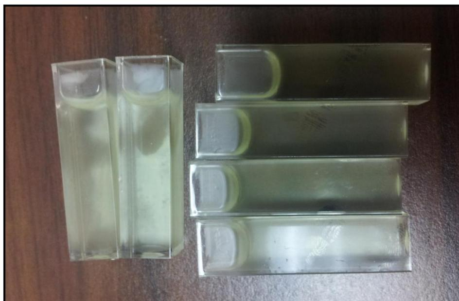
**Figure 12. PRESAGE<sup>®</sup> cuvettes for dose calibration**
